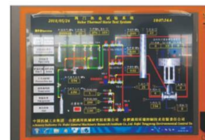
高温阀门热态研发、试验系统
