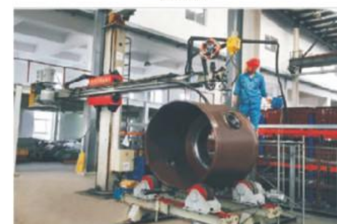
全自动埋弧焊接
