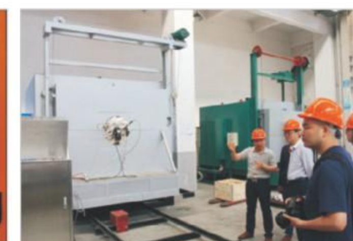
高温、带压、高频模拟工况试验台
